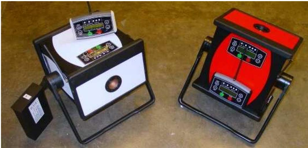
Afin de garantir la sécurité de l'opérateur lors du fonctionnement des appareils, une zone de sécurité doit être balisée par des lampes indiquant l'état de l'appareil (prêt à tirer : lampe verte ; en phase de démarrage : lampe orange ; en phase de tir : lampe rouge clignotante + avertissement sonore).
